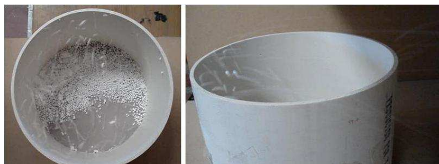
Figura 3: Ensayo de trayectoria con esferas de poliestireno expandido de baja densidad para el modelo de tanque B con un diámetro de 40 cm.
