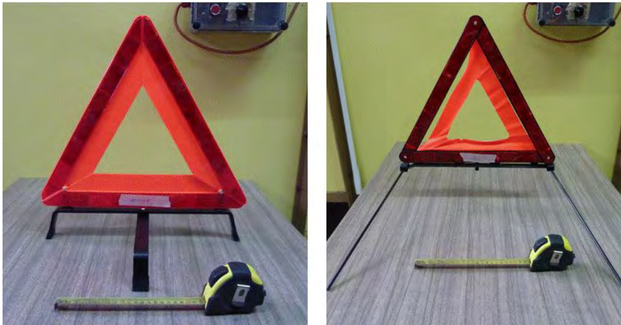
Fig. 1. Distintos tipos de balizas triangulares. El triángulo exterior tiene 0.45 m de lado.
