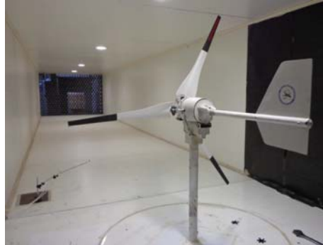
Figura 1. Generador ensayado dentro del túnel aerodinámico
